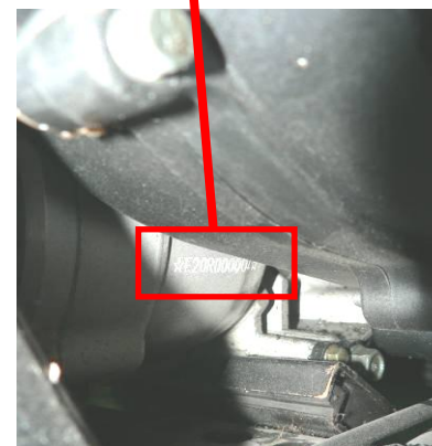
Umístění výrobního čísla motoru
